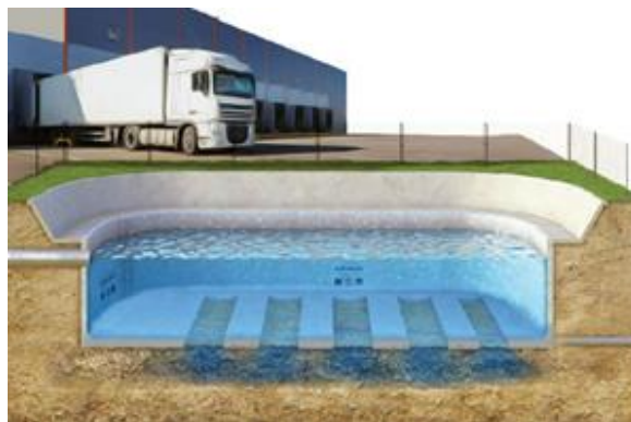
Rys. 6.74 System prefabrykowanych zbiorników żelbetowych 235
