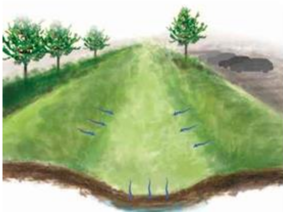
Rys. 6.58 Schemat niecki chłonnej na terenie otwartym i przykład na terenie silnie zabudowanym (osiedle Portland, Stany Zjednoczone) 229
